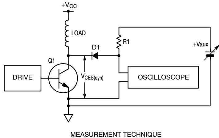
Figure 29. Dynamic  $V_{CE(sat)}$
