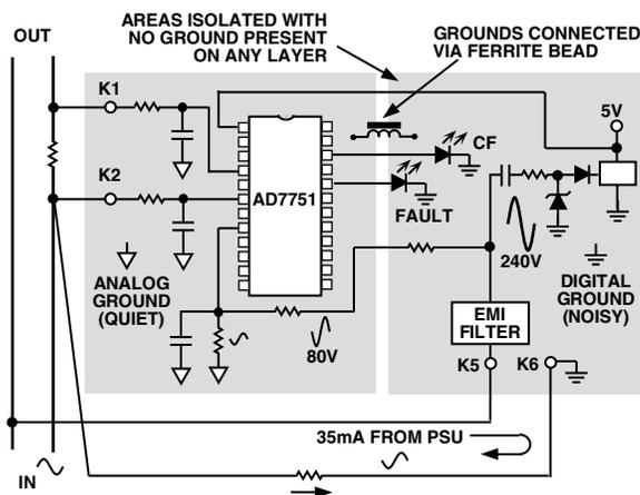
Figure 35. AD7751 Watt-Hour Meter PCB Design
