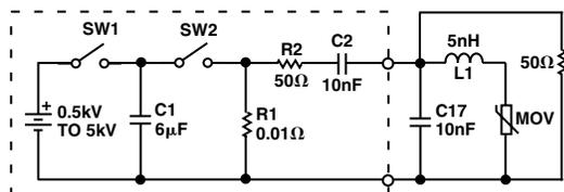
Figure 25. EFT Generator
