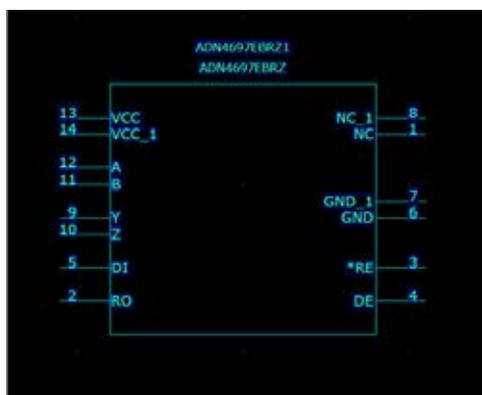
图7. Mentor PADS v9显示M-LVDS收发器ADN4697E元件
