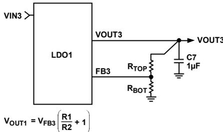
$$V_{OUT1} = V_{FB3} \left( \frac{R1}{R2} + 1 \right)$$
