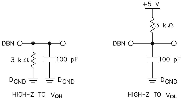
LOAD CIRCUITS FOR BUS RELINQUISH TIME ( $T_7$ )
