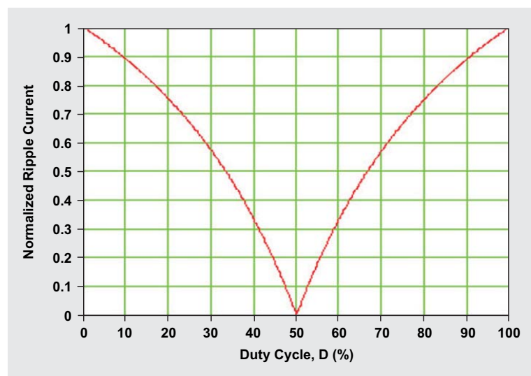
图 3 标准化电容器纹波电流为占空比的函数
